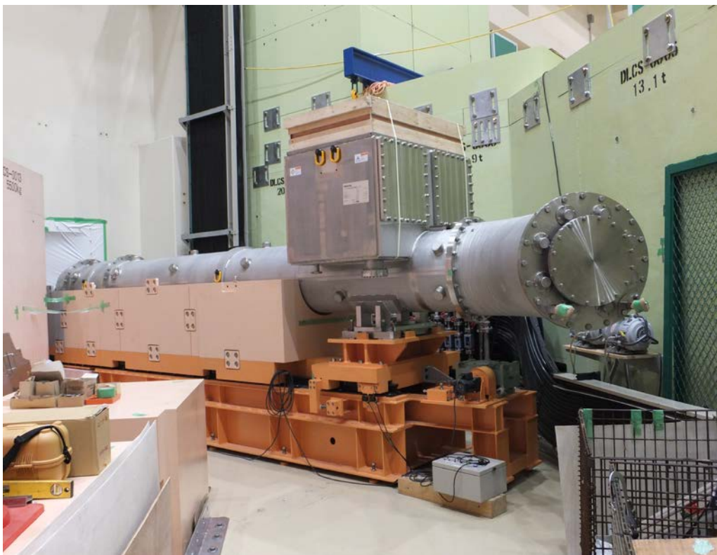
図1 インストール作業中の超伝導湾曲ソレノイド。
