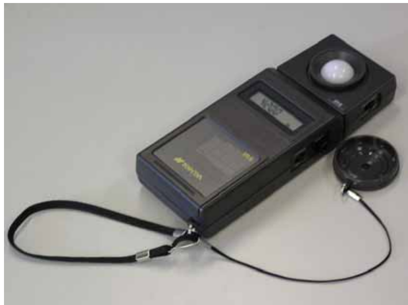
図 3-1-2.照度測定に使用したデジタル照度計 IM-5(トプコンテクノハウス株式会社製：測定上限は199900luxまで)
