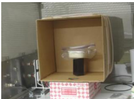
図 5.3.2-5 43 cm × 43 cm の段ボールに RG-213 の内線を 3 回巻いたソレノイドコイル 右は従来方式を用いて測定した HMT 414 g (3311 kHz) の NQR 信号。パルス出力 50 Ω 負荷に対して V_{pp} = 200 V、パルス幅 t_w = 100 μs、繰返し時間 2\tau = 2 ms、積算回数 N = 8192 回。
