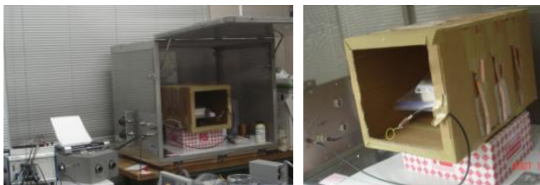
図 5.3.2-6 33.5 cm × 33.5 cm × 55.0 cm の段ボールに銅板製バンド ( d = 0.2 mm, 幅 = 18 mm) を 3 回巻きしたコイルを二つ並列接続したコイル
