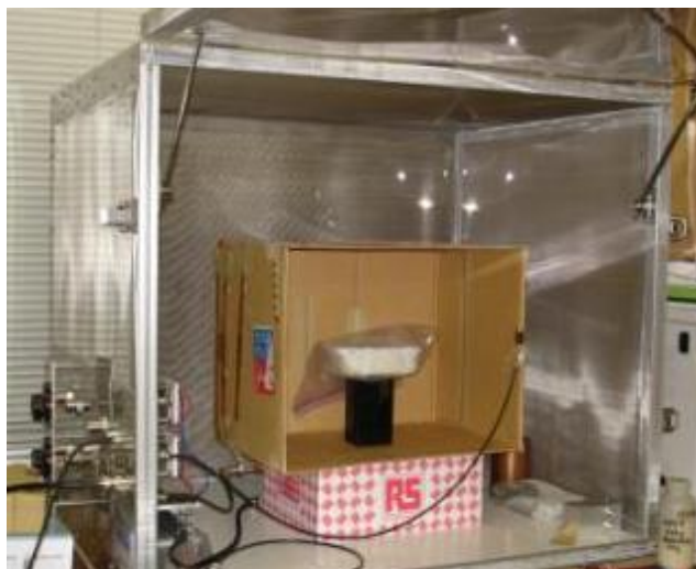
図 5.3.2-4 高さ 38 cm × 幅 51 cm の段ボールに銅板を 2 回巻いたソレノイドコイル
