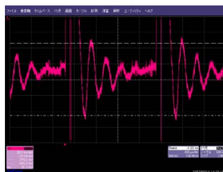
図 5.3.2-5 43 cm × 43 cm の段ボールに RG-213 の内線を 3 回巻いたソレノイドコイル 右は従来方式を用いて測定した HMT 414 g (3311 kHz) の NQR 信号。パルス出力 50 Ω 負荷に対して V_{pp} = 200 V、パルス幅 t_w = 100 μs、繰返し時間 2\tau = 2 ms、積算回数 N = 8192 回。
