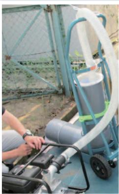
プラスチック製のタンクにプールの汚れた水を汲んで満たし、ゼオライトを入れて攪拌、水に溶けたセシウムを吸着し、さらに凝集剤でアオコ汚泥とともにそのゼオライトを凝集、沈ませて、きれいになった水と分け、Bq値をチェック
