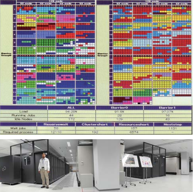
上:取材に訪れた際の、モニターに表示されたJSSの稼働率は94.28%。大きな計算には多くのCPUを使う必要があり、小さな計算なら少ないCPUです。できるだけ空気が出ないようジョブを割り振るスケジューリング管理能力もスーパーコンピュータの重要な能力だが、90%を超える稼働率は世界でもトップクラス水準だ 下:2009年度から運用を開始した「JSS」
