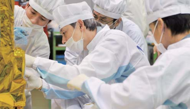
左:多層断熱材の取り付け作業中の「現代の名工」西根成悦氏(左から2人目)画像:NEC 右:「SPRINT-A」の実物大模型を前に
