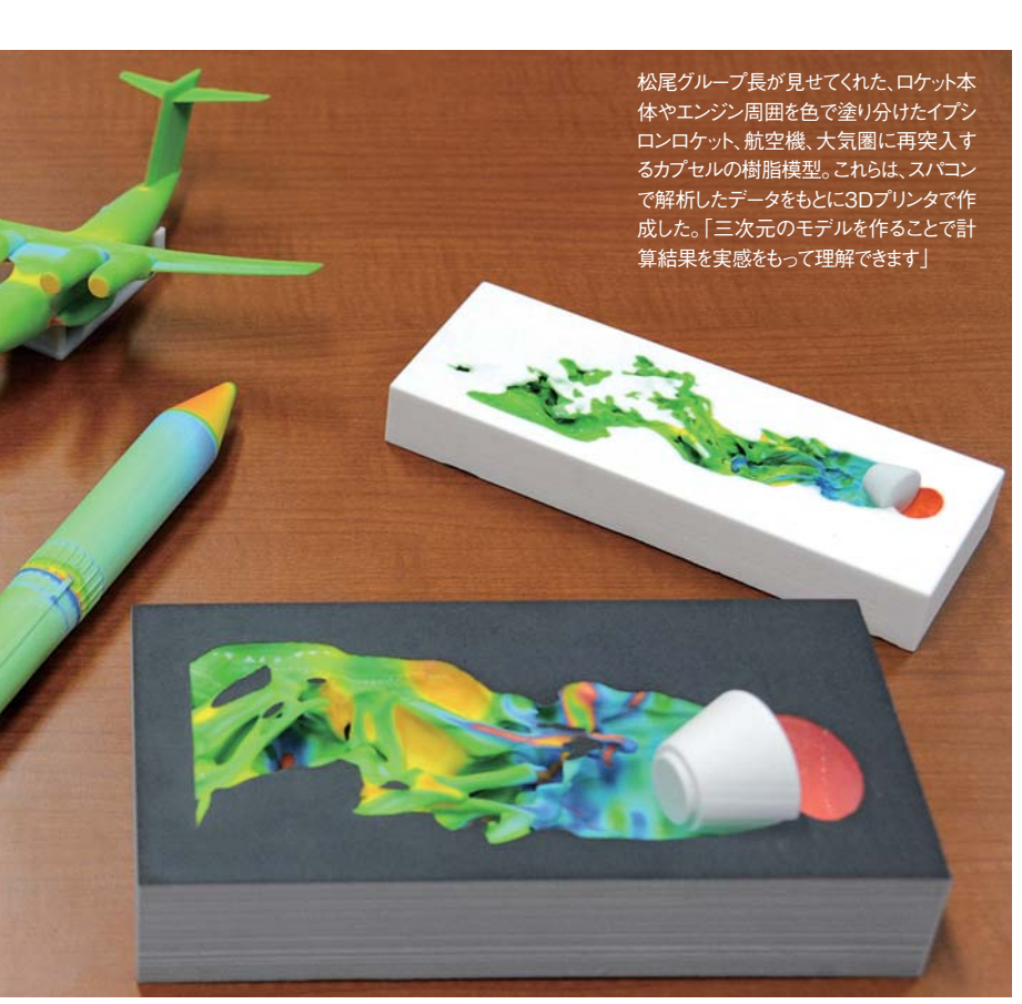
松尾グループ長が見せてくれた、ロケット本体やエンジン周囲の色を塗り分けたイプシロンロケット、航空機、大気圏に再突入するカプセルの樹脂模型。これらは、スーパーコンピュータで解析したデータをもとに3Dプリンタで作成した。「三次元のモデルを作ることで計算結果を実感をもって理解できます」
