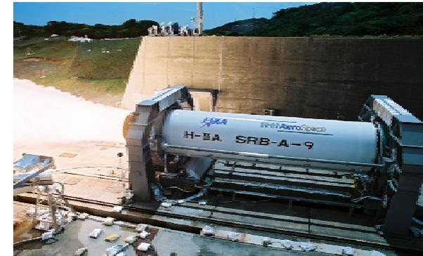
SRB - A改良型地上燃焼試験
