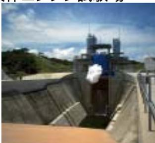
純国産のH-IIロケットの心臓部ともいえる第1段エンジン(LE-7)の地上燃焼試験を行った設備で、現在はH-IIAロケットの第1段エンジン(LE-7A)の地上燃焼試験を行っている。
