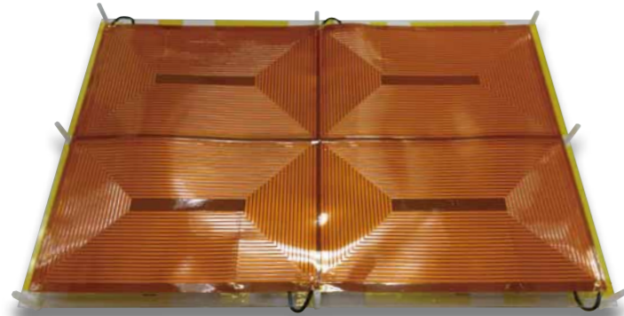
衛星構体取付コイルアレイモデル 衛星構体に取り付けて電力供給用として用いる磁界結合用コイルアレイのモデル。薄く自由に曲げられるFPC (Flexible Printed Circuits:プリント配線基板)を採用することで、軽量で設置形状の自由度を高めることを目指している。
