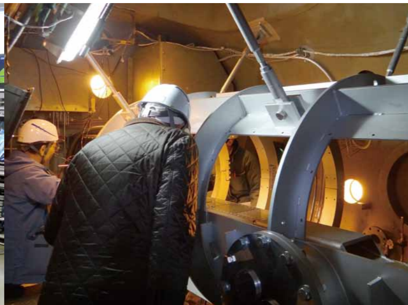
燃焼試験設備の一部である「低圧室」。直径3m、長さ6mあり、マッハ4、6、8相当の飛行環境を作り出せる。
