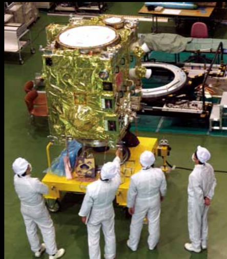
「あかつき」の最後の調整を行う製造チーム。上部に見えるのが高利得平面アンテナ(写真・山根一真)。
