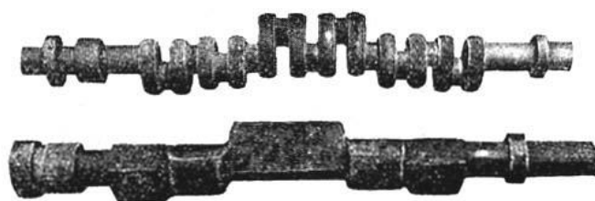
図 36 直列 6 気筒クランク軸粗形材……自由鍛造粗形材と RR 鍛造粗形材との比較
