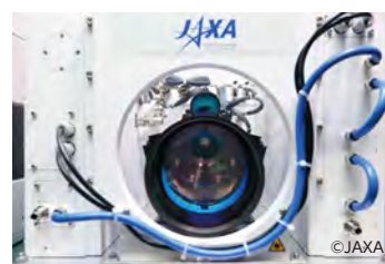
JAXAが開発した晴天乱気流検知システムのドップラーライダー
