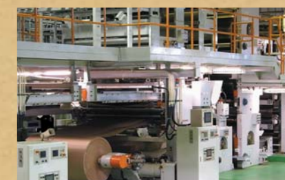
毎分450mという、世界最高の段ボールシート生産速度を実現した三菱コルゲートマシン。
