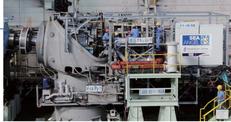
2012年に実施されたDDTの性能試験の様子
