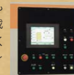
機械・製品の状態を確認しながら、容易に調整が行える集中操作パネル。
