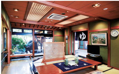
湯上りお休み処の照明 LED電球に更新し、人感センサーも使用して、人の動きを検知してON/OFF制御
