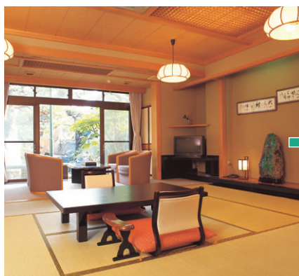
西殿客室の既存の照明 ベース照明は白熱灯ペンダントを使用
