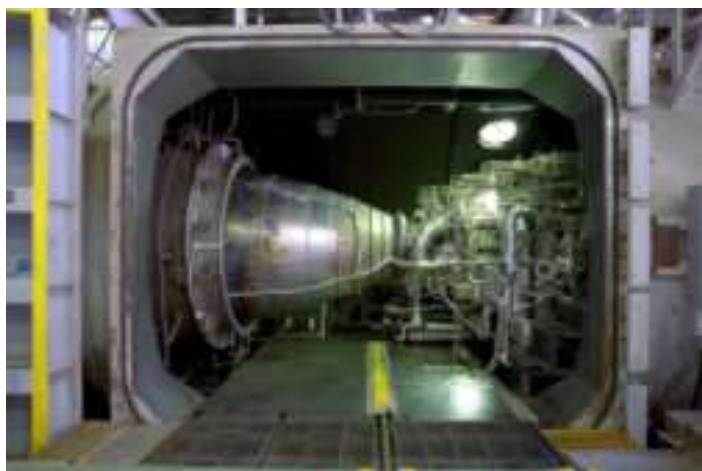
LE-5B-2エンジン開発試験 (於角田宇宙センター 高空燃焼試験設備)
