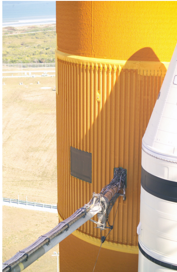
水素ガスベントライン
