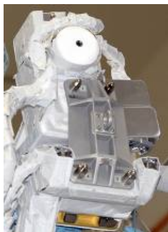
船外実験プラットフォームの視覚装置の打上げ時の収納場所と取付け位置
