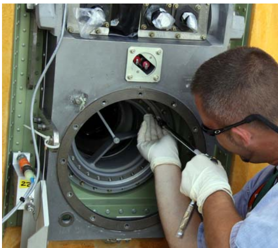
GUCPの内部シールを取り外している
