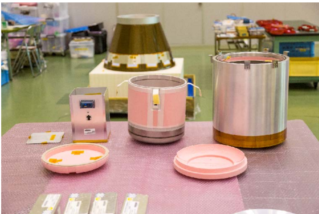
図 6.1-3 HTV 搭載小型回収カプセルと試料収納部の構成 (JAXA)
