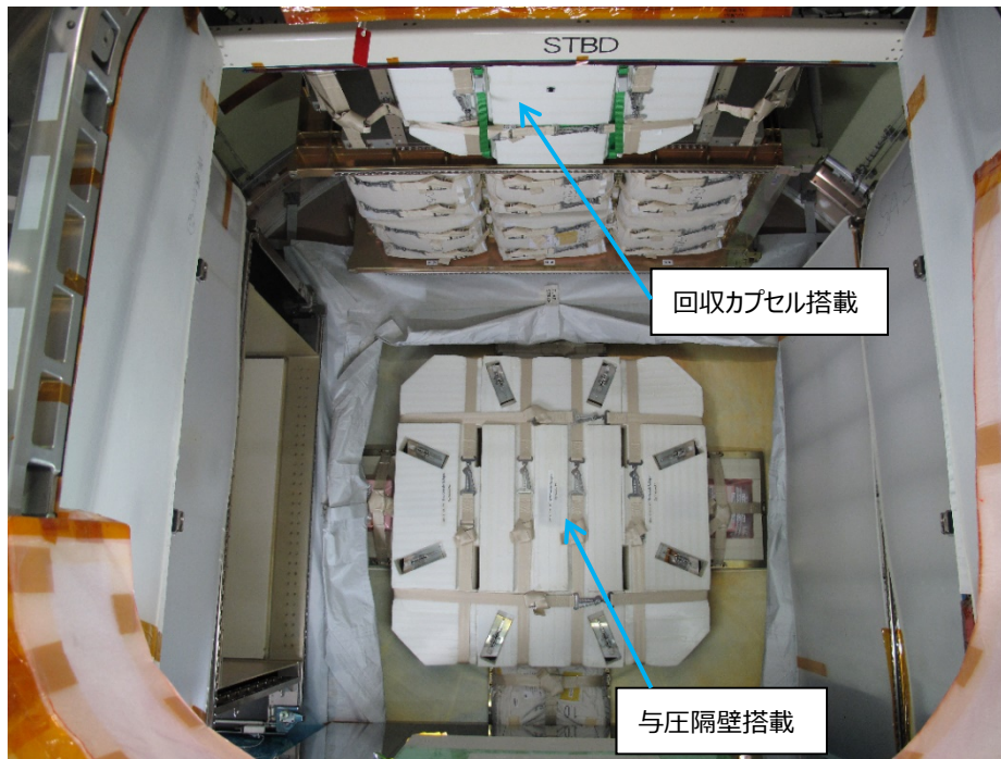
図 6.1-6 打ち上げ時の HTV 搭載小型回収カプセルの搭載場所 (JAXA)
