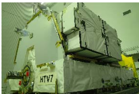
「こうのとり」の曝露パレットへのバッテリー 6 台の設置*3
