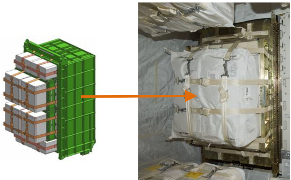
図 5.1-6 ラック前面へ搭載された物資輸送用バッグ (CTB) の例 (2号機) (JAXA)
