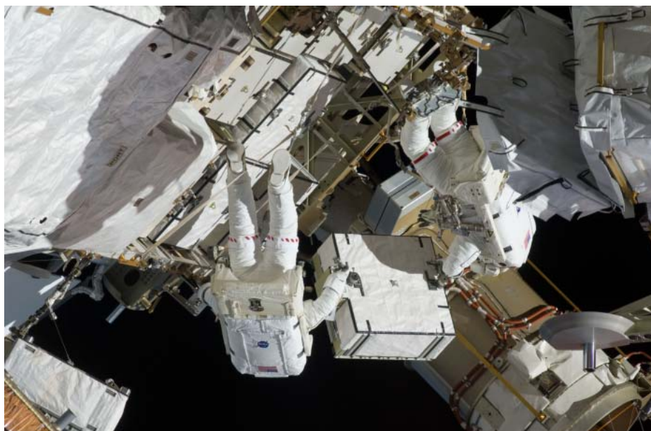
図 5.2-8 STS-127 ミッション時に行われた船外活動によるバッテリー交換作業の様子（NASA） https://spaceflightsystems.grc.nasa.gov/sopo/ihho/iss-technology-demonstration/sustaining-engineering-of-eps-hardware/s127e008452/
