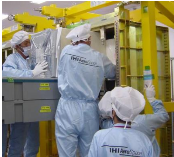
図 5.1-5 HTV 補給ラック (HRR) に搭載される物資輸送用バッグ (CTB) (JAXA)
