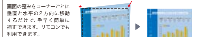
クイックコーナーにて各コーナーごとに歪みを補正 四辺が見やすい画面に
