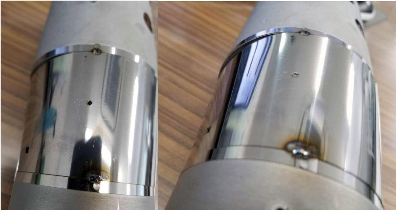
スポットのタイミング(時間)が同じステンレス素材でもフィニッシュが異なると難しいようです
