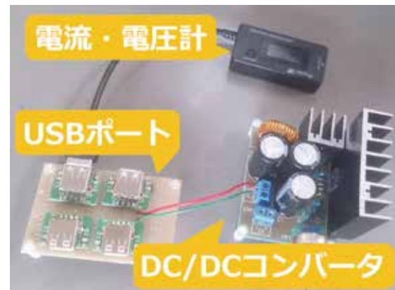
図2 太陽電池の周辺機器
