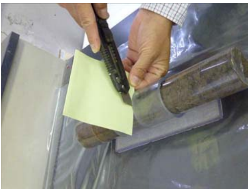
土壌がくずれやすい場合は薄いプラスチックの板を切り目に挿入しながら切断
