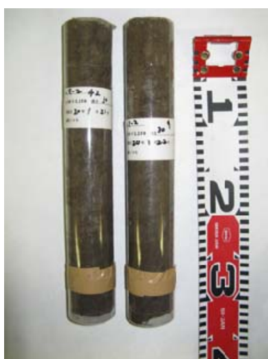
ライナーの外側に刃先まで土が残っている場合には、切り落とす。(5)
