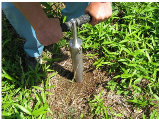
採土器を垂直におき、荷重をかけながらハンドルを回して押し込む。(2)
