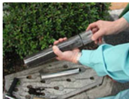
円筒ライナーにキャップを付け、試料名等を記載する。(6)
