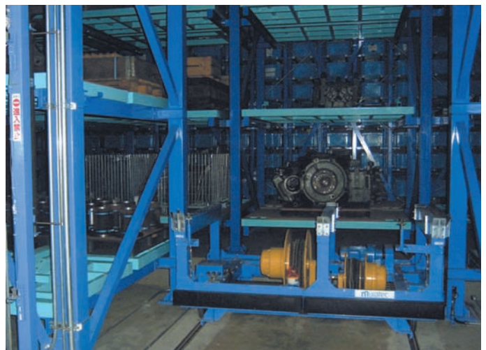
大型の機器から小さなパーツまで収納できる立体自動倉庫
