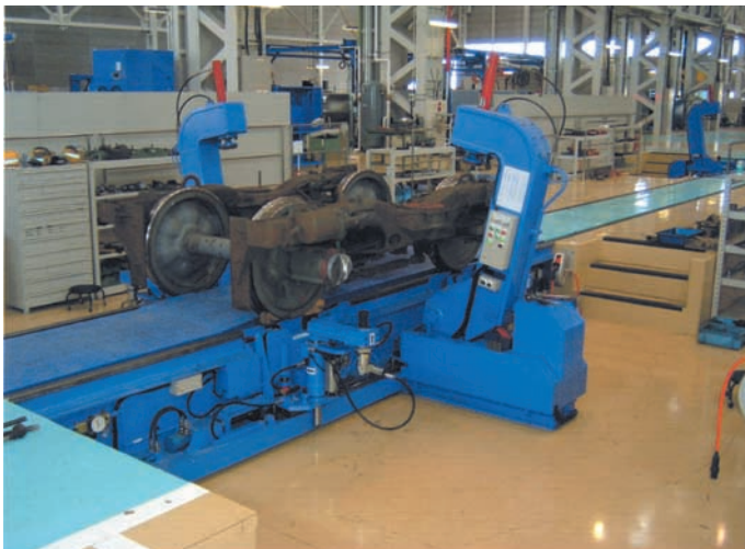
台車分解組立装置
