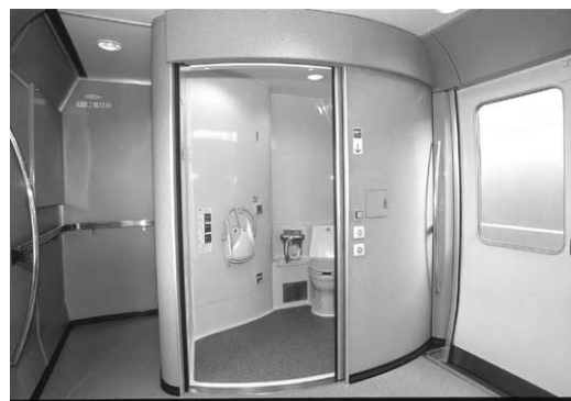
写真-1 ワイドビューひだ号のバリアフリー化改造トイレ
