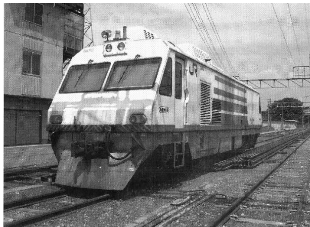
写真-1 従来のレール探傷車（RFD）
