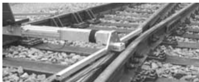
写真-2 分岐器通過用アタッチメント
