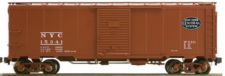
ベッテンドルフ台車が特徴の、プレーキホイールが、大抵は妻面か、屋根上の比較的高い位置に取り付けられている全鋼製ボックスカー残念ですが鉄製のカブス(Steel Caboose)は全て売り切れているようです。。(残念)
