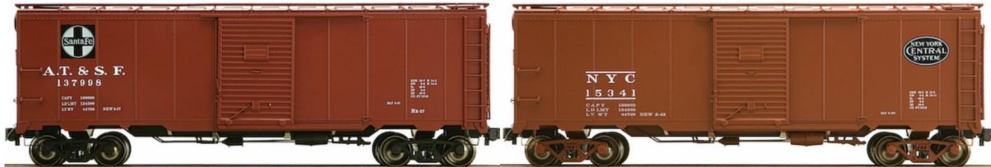
ベッテンドルフ台車が特徴の、プレーキホイールが、大抵は妻面か、屋根上の比較的高い位置に取り付けられている全鋼製ボックスカー残念ですが鉄製のカブス(Steel Caboose)は全て売り切れているようです。。(残念)
