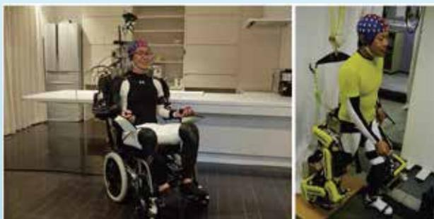
脳活動からの動作意図推定による装着型ロボット制御
