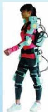
CNTフレキシブルセンサを用いて滑らかに動作するアシストスーツ
