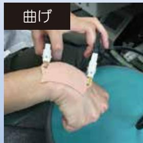
CNTフレキシブルセンサにより手首の動きを検出している様子
