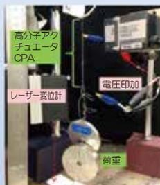
アクチュエータ特性評価（電圧、電流、変形、力、温度）の様子。モデル化、制御設計。
