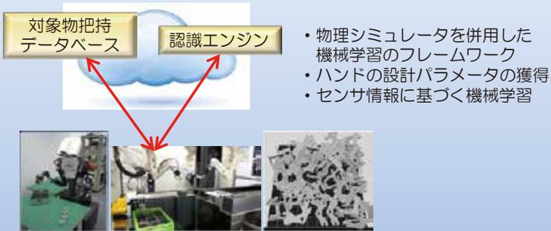
バラ積みピンピッキングの機械学習システム
