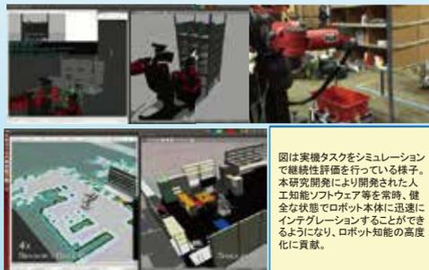
図は実機タスクをシミュレーションで継続性評価を行っている様子。本研究開発により開発された人工知能ソフトウェア等を常時、健全な状態でロボット本体に迅速にインテグレーションすることができるようになり、ロボット知能の高度化に貢献。
