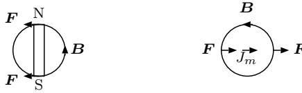
図 12.9 回転のある磁場中の磁化にかかる力。 左: 磁荷分極モデル、右: 磁化電流モデル
