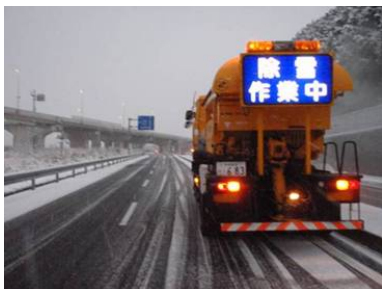
凍結防止剤散布状況
