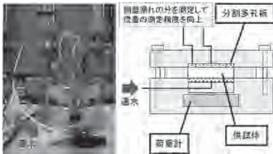
図2 ベントナイトの透水試験装置
