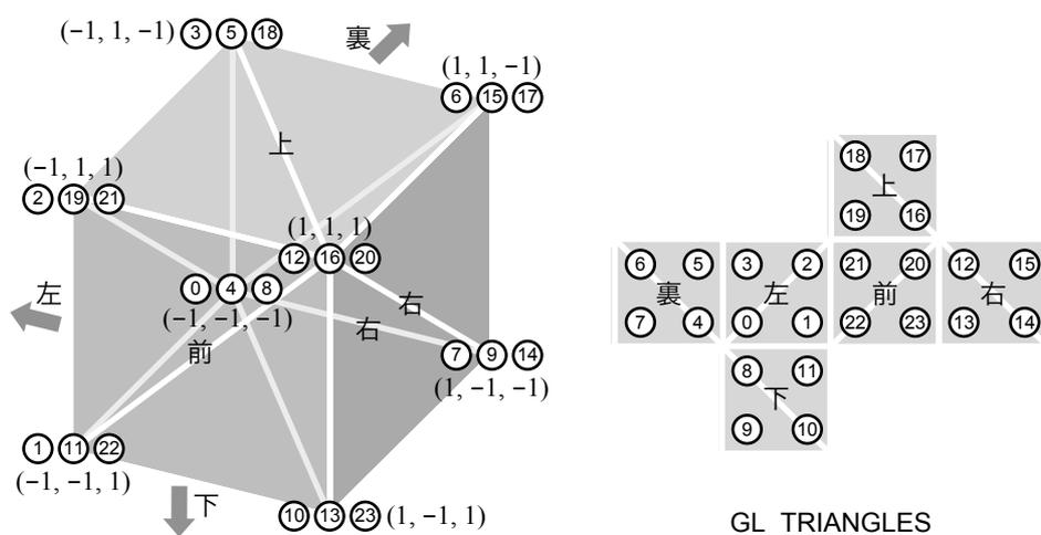
図 120 インデックスを使って六面体の各面を `GL_TRIANGLES` で表す場合
