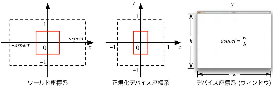
図 62 ウィンドウの縦横比  $aspect$  をワールド座標に反映
