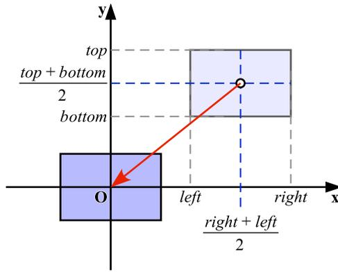
図 99 中心が原点となるように平行移動
