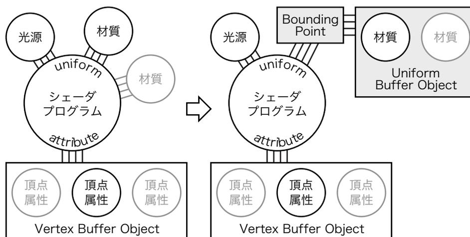
図 170 Uniform Buffer Object と Bounding Point
