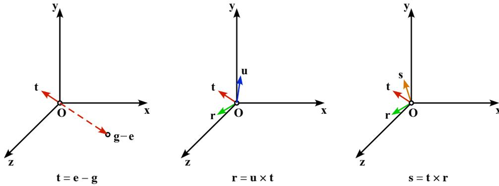
図 93 視点座標系の軸ベクトル (r s t)
