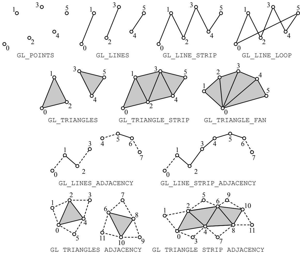
図 55 OpenGL の基本図形
