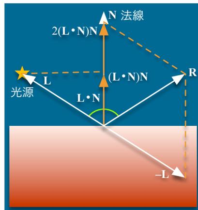
図 144 正反射方向のベクトル  $\mathbf{R}$
