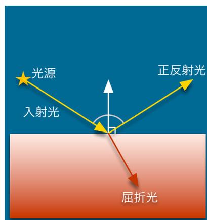
図 135 正反射光と屈折光
