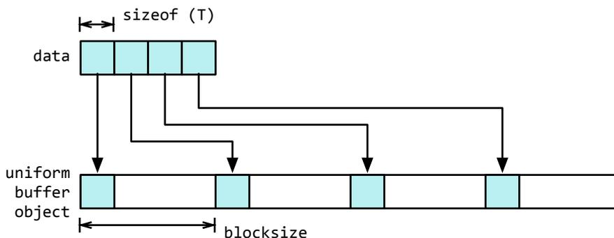
図 173 ユニフォームバッファオブジェクトへの複数のデータの格納
