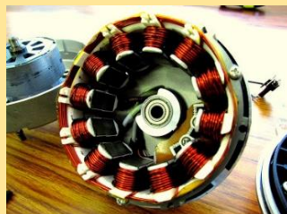
SANYO エネループバイク モーターユニット部分の構造 http://fiction-cycles.blogspot.jp/2012/01/sanyo_02.html より
