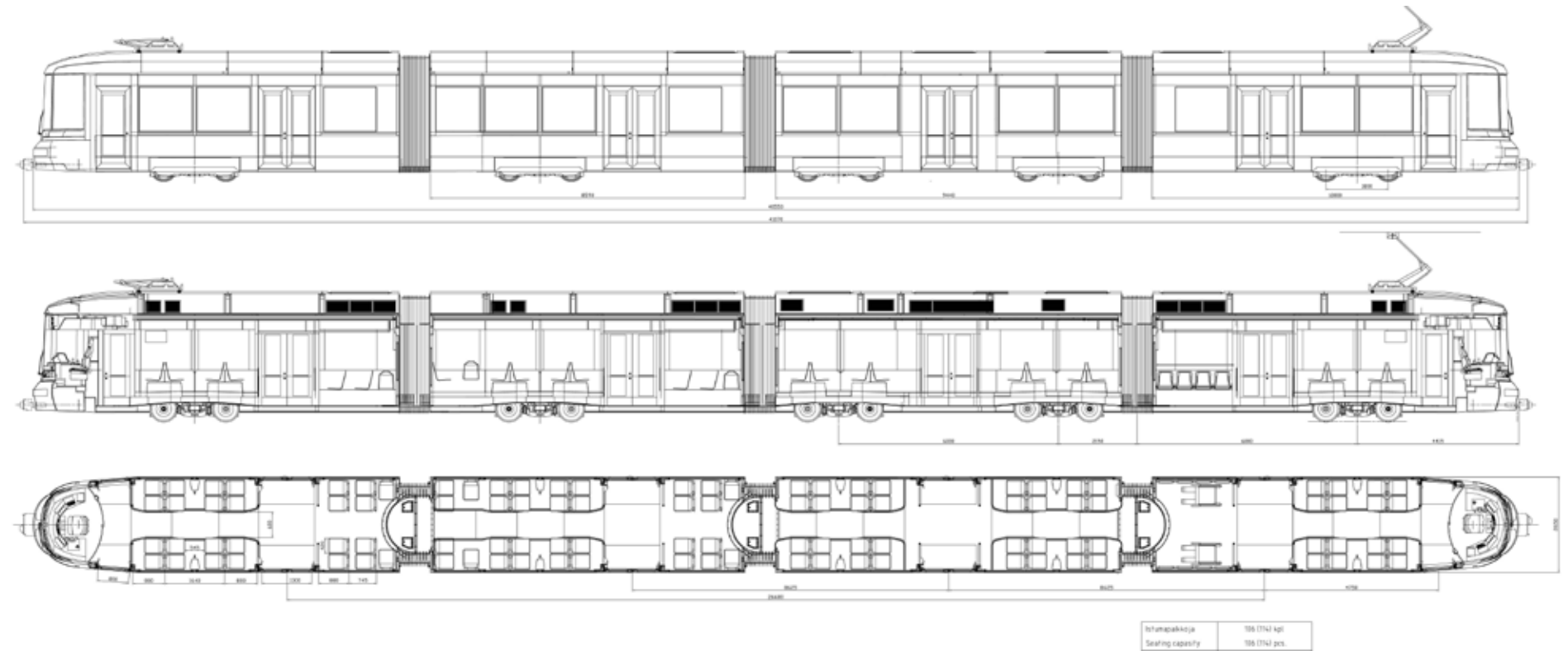
Kuva 28. Esimerkki 41 metriä pitkästä raitiovaunusta. Vaunussa on 106 istuma- ja 180 seisomapaikkaa eli kapasiteetti on yhteensä 286. Lähde: Trans-tech.
