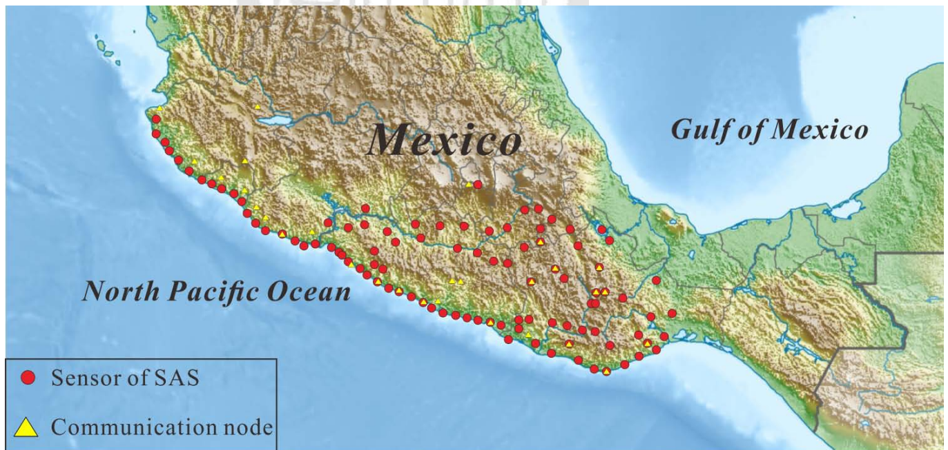
圖 1-9 墨西哥 SAS 預警系統測站分布 (修改自 UC Berkeley Seismological Laboratory)
