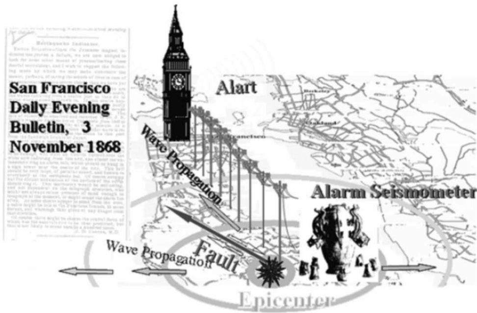
圖 1-3 由美國地震學家 Cooper 提出之最早地震預警概念示意圖 (Nakamura and Tucker, 1988)
