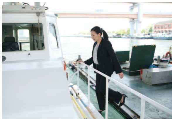
水先人を送迎するパイロットボート。航行中の大型船に横付けしたこの船から、最長9メートルの縄ばしごで乗船する。
