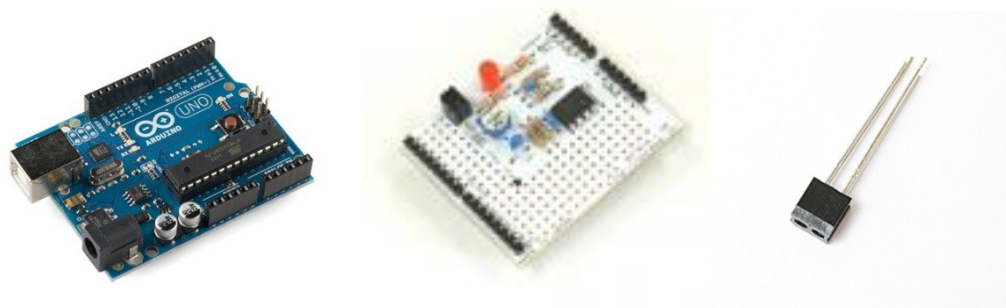
図1 左：Arduino Uno R3, 中：A.P. Shield 05, 右：フォトセンサ
