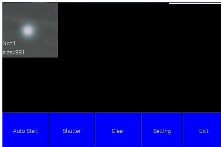
選択した星が表示されます。以後、[Shutter]ボタンをタップするごとに、撮影し、同じ場所の画像を拡大表示していきます。
