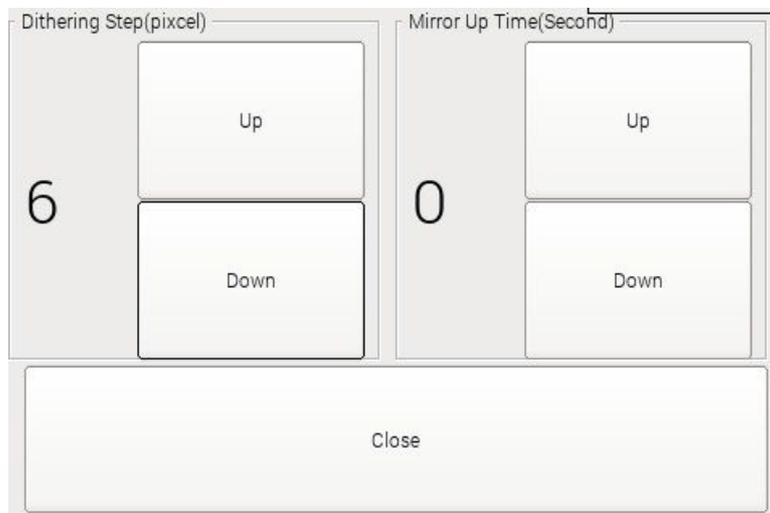
ここでディザーリングの移動量をピクセルで指定します。
