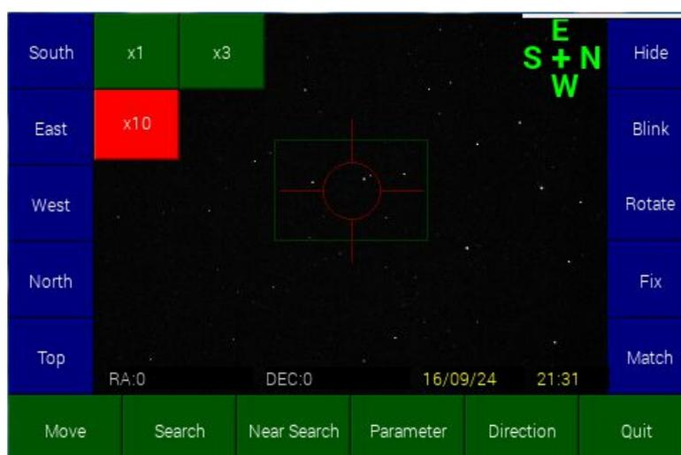
この状態で、画像のだいたい右部分をタップするとセンターマークが右に移動します。同様に画像の4方向をタップするとその方向にセンターマークが移動します。
