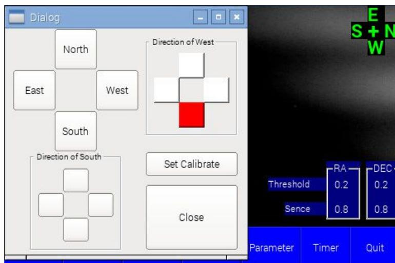
[Direction of West]の枠の中で星が動いた方向のボタンをタップして赤くします。上の例では、星が下に動いた場合です。
