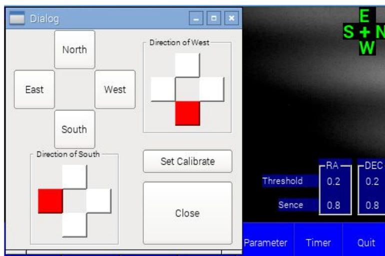
[Direction of South]の枠の中で星が動いた方向のボタンをタップして赤くします。上の例では、星が左に動いた場合です。
