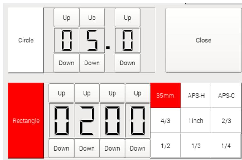
アイピースなど円形視野の場合は[Circle]を選択し、視野角を入力してください。上記例は5度です。写真の場合は、[Rectangle]を選択し、光学系の焦点距離、およびセンサーサイズを選択します。以上で設定は終了です。
