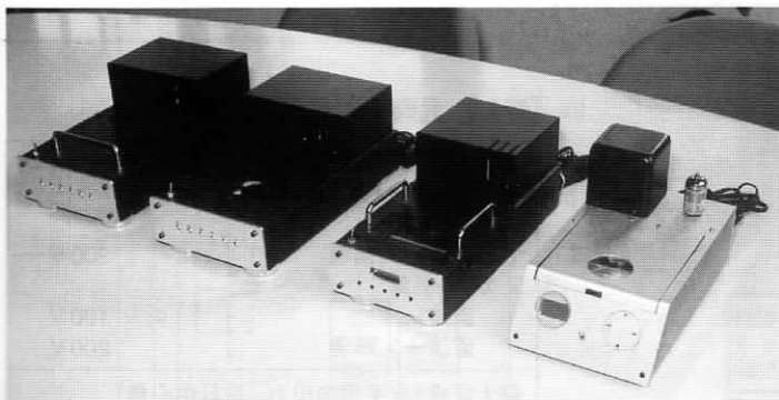
歴代のCDプレーヤーキット。右から試作機(内部のメカニズムはソニーのプレーヤーを使用)、初代TU-876CD(2001年)、TU-878CD(2003年)、最新モデルTU-881CD(2005年)
