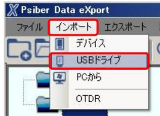
4. 試験結果インポート画面から『 E: 』を選択して『インポート』をクリックします。サイト選択画面が現れます。インポートするサイトを選択して『選択したファイルのインポート』もしくは、『全てインポート』を選択してインポートを実行します。自動的に USB から eXport にテスト結果がコピーされます。
