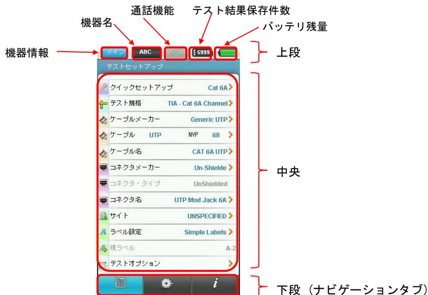
画面下部のワンタッチアクセスセグメントでは、オートテスト、機器のセットアップ、データベースの表示/編集、その他の設定画面への切り替えがワンタッチで行えます。
