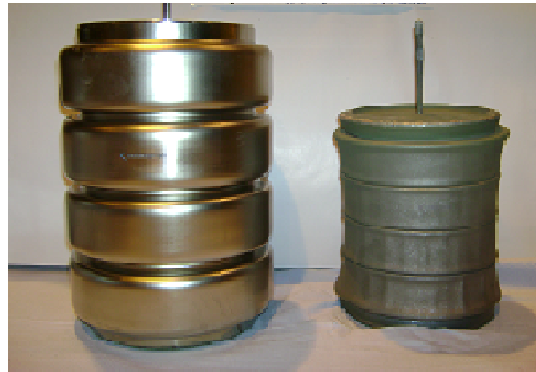
図 3 英国で不純物の入ったプルトニウムの固定化用に計画されている技術 左側の容器には、粉末状の物質が入っている。プルトニウム処分用の場合には、プルトニウム、カルシウム、ジルコニウム、チタンの酸化物の混合物が入る。右側は、8～9 時間、「熱間等方圧加圧法(HIP)」処理を施した結果、粉末が 5 リットルの固体セラミックになったもの。提供：英国国立原子力研究所 (NNL) 37
