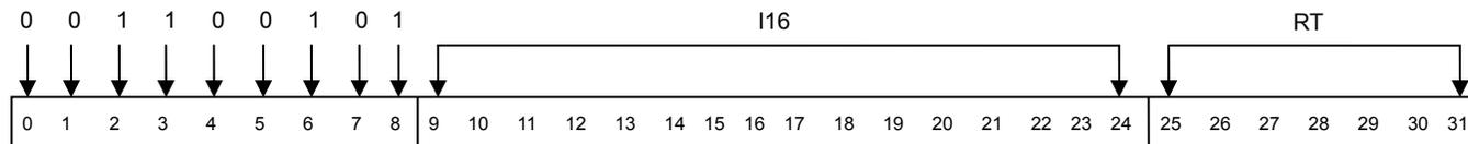
I16 フィールドの各ビットを 8 回コピーすることによって、レジスタ RT にマスクを生成する。オペランドのビットは、左から右に、結果のバイトに対応する。
