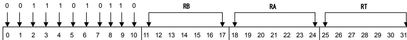
レジスタ RA のプリファード・スロットの値をレジスタ RB のプリファード・スロットの値に加算し、最下位の 2 bit を強制的に 0 にすることによって、4 bit のアドレスを算出する。このアドレスは、クワッドワード内のアラインされたワードのポジションを決定するために使用される。このポジションを基に、**shufb** 命令で使用できるマスクを生成する。**shufb** 命令では、クワッドワード内の指定ポジションにワードを挿入する。このワードは、**shufb** 命令の RA オペランドのプリファード・スロットから取得する。
