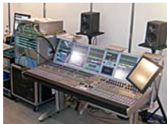
①最大プロセッシング数は640チャンネル。②メインまたはグループ出力が使用可能な128系統のプログラムバス。メイン出力:最大16系統(ステレオまたは5.1chサラウンドメインバスで構成)/グループ出力:最大48系統(モノラル、ステレオまたは5.1サラウンドグループバスで構成)。④64系統のマルチトラック/IFBバス。⑤32系統のAUXバス。などのスペックをもつ。
