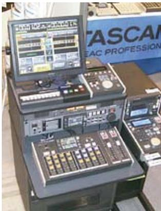
■ **花岡無線電機製品**: ①「VGABOX 取り付け金具」…「VGABOX」を15インチモニターの背面に取り付けが可能。②モニターパネル…1Uタイプのモニターパネルで4つのステレオ入力素材を切替えて音声出力を確認することができる。③PON出しSUBRACK…上段に3U、下段に10Uのラックマウント実装ができ、PC-HS32PDを設置することができるテーブルが用意されている。RC-HS32PDを使用しない時は、RACK部に格納することができる。キャスター付きで可動することができる。
