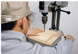
テーブル固定ハンドルを回して高さを調整し、テーブルを固定する。
