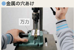
●金属の穴あけ 材料を万力(ワッシャー)にしっかり固定し、ゆっくり送りハンドルを下げる。
