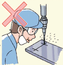
●通し穴のバリ取り あけた穴よりも直径の大きいドリルで軽く削る。
