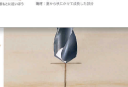
ドリルの先端を穴あけの中心に合わせて、クランプで材料を固定する。
