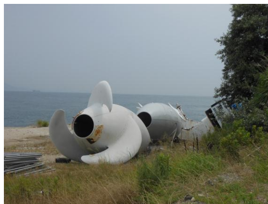
明石海峡の潮流を利用しての実験に使われた水流タービン（まぐろ型プロペラ）
