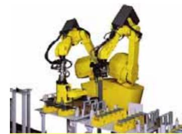
双腕知能ロボットによるミニロボットの自動組立システム (ファナック)
