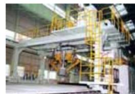
橋梁溶接ロボットシステム (神戸製鋼所)
