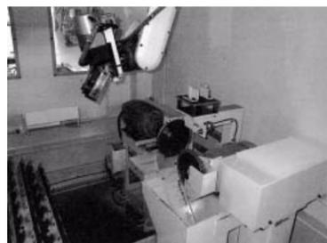
鋳鉄バルブ素材バリ取りシステム (豊田工機)
