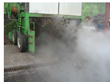
切りかえし用の機械 1 週間に 1 回機械の上部から E M 散布
