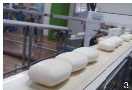
3. 型抜きされ、シャボンちゃんのしるしがされた固形石けん。
