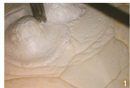
1. 苛性ソーダと天然油脂をタンクの中で反応させている様子。工場の中はほんのり油のいい香りがしました。
