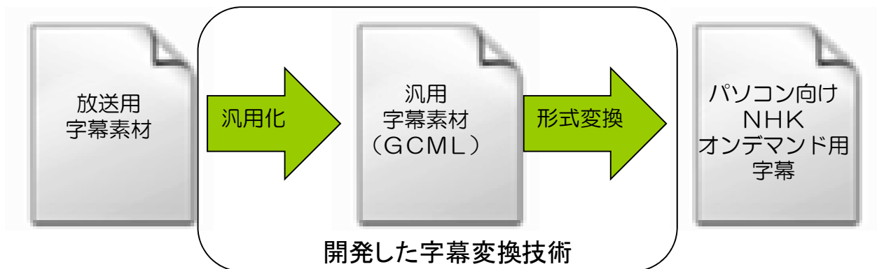
図2 字幕変換の流れ
