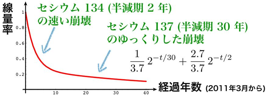
図 5.5 地面に付着した放射性セシウムがまったく移動しないと仮定したときの、セシウムからの放射線の空間線量率の時間変化。2011年3月での線量率を1として、40年間の変化をグラフに描いた。最初の2,3年は半減期が2年のセシウム134が急激に減衰するために線量率はどんどん下がる。しかし、その後は、半減期が30年のセシウム137が主になるので、線量率はほとんど減らなくなってしまう。
