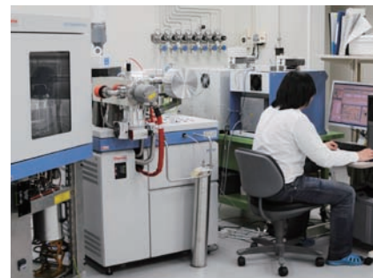
質量分析装置による安定同位体分析 Stable isotope analysis by a mass spectrometer
