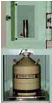
半導体検出器 放射線のエネルギー分布を測るもの。放射性核種の種類を調べるのに利用する。
