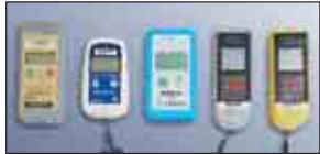
② 空間の放射線量を調べる 簡易放射線測定器「はかるくん」(シンチレーション式サーベイメータ) 空間の放射線量を測るもの。身の回りの放射線(ベータ(β)線、ガンマ(γ)線)を調べることができる学習用の測定器です。(単位:μSv/h)
