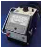
電離箱式サーベイメータ 放射線量を測るもの。放射線によって電離されて放出されるイオンの量から放射線の量を調べる。
