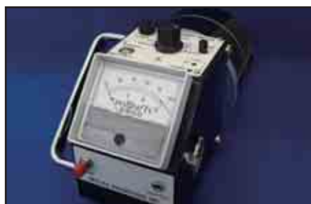
②空間の放射線量を調べる 電離箱式サーベイメータ 放射線量を測るもの。放射線によって電離させて放出されるイオンの量から放射線の量を調べます。(単位: \mu\text{Sv/h} )
