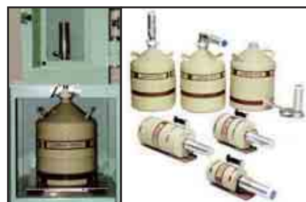
①放射性物質の有無を調べる ②空間の放射線量を調べる 半導体検出器 放射線のエネルギー分布を知るもの。放射性物質の種類を調べるのに利用します。(単位:eV)
