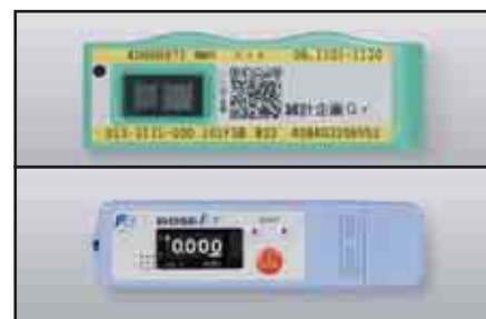
③個人の被ばく線量を調べる 個人線量計 個人が受ける放射線量を測るもの。放射線量を知らずとも使えます。(単位:mSv) (注)個人被ばく線量計は、携帯電話などからの電気的ノイズにより誤計数する場合がありますので、携帯電話などと同じポケットに入れて使用しないこと。
