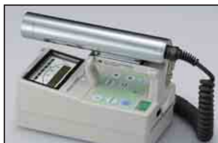
②空間の放射線量を調べる シンチレーション式サーベイメータ 空間の放射線量を測るもの。放射線による人体への影響を調べるのに利用します。(単位: \mu\text{Sv/h} )
