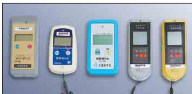
②空間の放射線量を調べる 簡易放射線測定器「はかるくん」(シンチレーション式サーベイメータ) 空間の放射線量を測るもの。身の周りの放射線(ベータ( \beta )線、ガンマ( \gamma )線)を調べることができる学習用の測定器です。(単位: \mu\text{Sv/h} )
