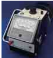
電離箱式サーベイメータ 放射線量を測るもの。放射線によって電離されて放出されるイオンの量から放射線の量を調べる。
