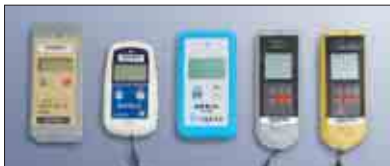
② 空間の放射線量を調べる 簡易放射線測定器「はかるくん」(シンチレーション式サーベイメータ) 空間の放射線量を測るもの。身の回りの放射線(ベータ(β)線、ガンマ(γ)線)を測ることができる学習用の測定器です。 (単位:μSv/h)
