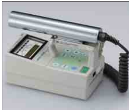
②空間の放射線量を調べる シンチレーション式サーベイメータなど 空間の放射線量を測るもの。放射線による人体への影響を調べるのに利用します。 (単位: \mu\text{Sv/h} )
