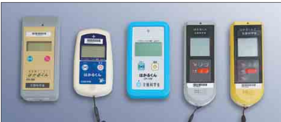
②空間の放射線量を調べる 簡易放射線測定器「はかるくん」(シンチレーション式サーベイメータ) 空間の放射線量を測るもの。身の回りの放射線(ベータ( \beta )線、ガンマ( \gamma )線)を調べることができる学習用の測定器です。 (単位: \mu\text{Sv/h} )
