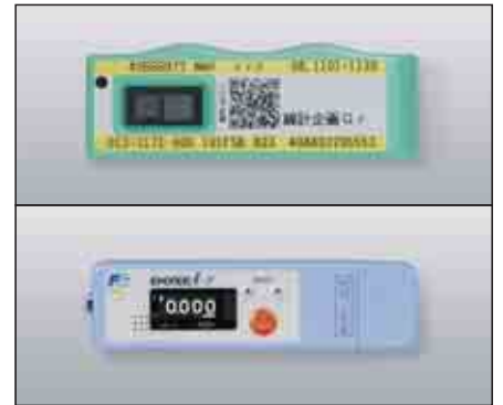
③個人の被ばく線量を調べる 個人線量計 個人が受ける放射線量を測るもの。放射線量を知りたい時にも使われます。 (単位:mSv) (注)個人被ばく線量計は、携帯電話などからの電氣的ノイズにより誤計数する場合があるので、携帯電話などと同じポケットに入れて使用しないこと。
