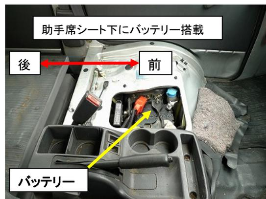
写真3-2 自動車Bのバッテリー搭載位置
