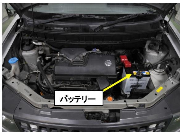
写真3-3 自動車Cのバッテリー搭載位置
