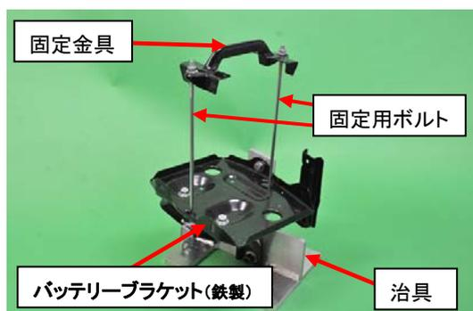
写真4-1 自動車 A バッテリーブラケット及び治具
