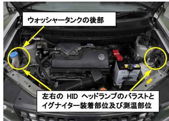
写真6-2 エンジンルームの HID バルブのバラストとイグナイター測温部位
