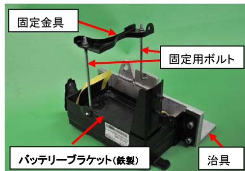
写真4-2 自動車 B バッテリーブラケット及び治具
